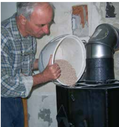
Het vullen van de Thermobox met Magnetherm-granulaat
